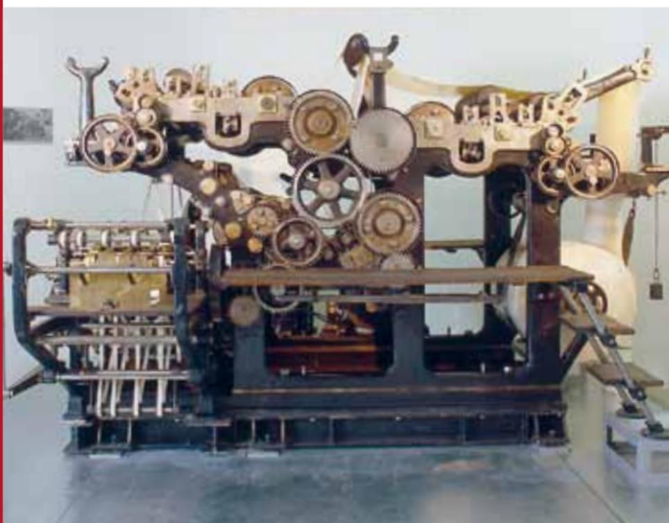
**Zeitungsdruck: Rotationsdruckmaschine von 1896**
